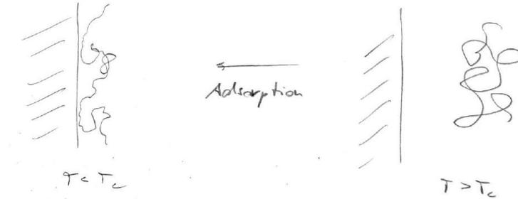
Abbildung 5.15: Adsorptionsübergang bei  $T = T_c$ . Die Adsorption ist ein Phasenübergang im thermodynamischen Limes  $N \rightarrow \infty$ .
