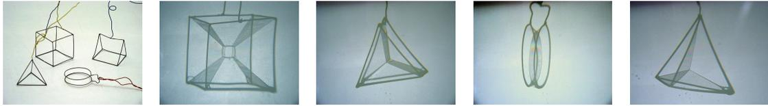
Abbildung 7.1: Metallrahmen aus der Versuchssammlung. Seifenhäute bilden Minimalflächen zwischen den Metallrahmen aus. Zwischen zwei kreisförmigen Ringen bildet sich ein Katenoid, siehe auch Aufgabe 3.
