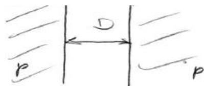
Im Limes  $R \gg D$  verwenden wir die **Derjaguin-Approximation**, bei der die Kugel in Halbräume zerlegt wird. Für zwei Halbräume  $p$  im Abstand  $D$  gilt nach Gl. (4.2.10) (mit  $D$  statt  $2D$ )
